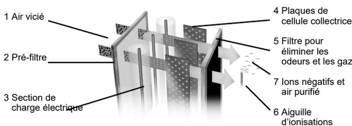
L'air vicié est attiré dans la grille à l'avant et passe par un système de filtrage à 4 étapes.
